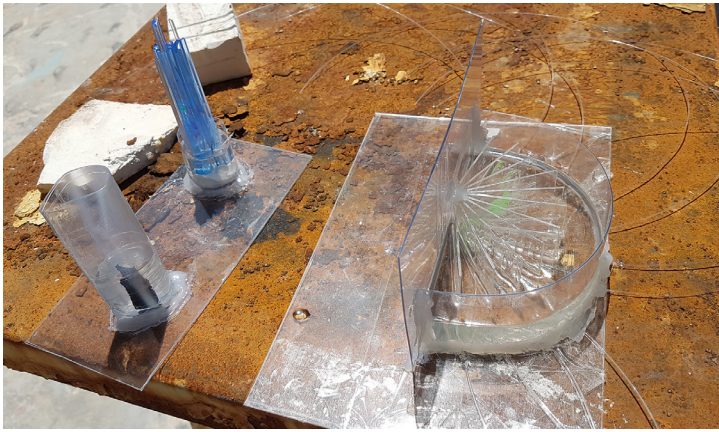
Figura 66. Pruebas de encapsulado con metacrilato y fibra óptica. Creación propia.
