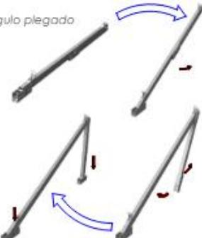
Apriete de las uniones y anclaje al suelo mediante tornillo de hasta M10.
