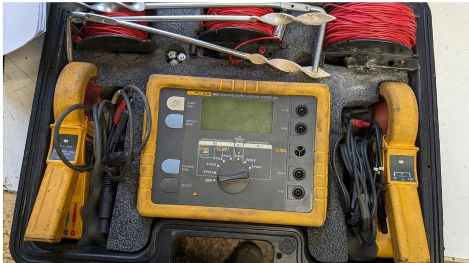
Figura 36. Telurómetro utilizado para medir la resistividad del terreno.
