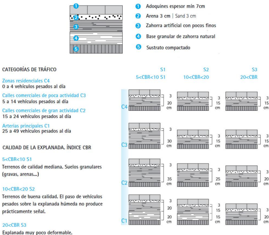
Figura II.5. Secciones de pavimentos permeables recomendadas según categoría de tráfico y calidad de explanada (Adaptado de Breinco, s.f.).
