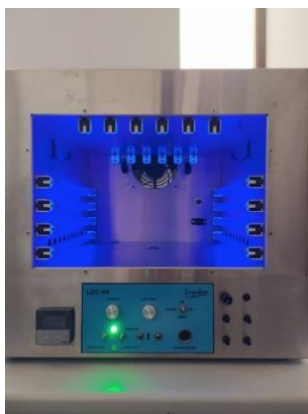
Figura 84. Fotorreactor LuzChem modelo LZC-4V equipado con 8 lámparas halógenas de Xe de 8 W cada una y que emiten luz con \lambda_{em} = 352 nm
