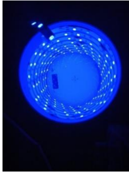
Figura 85. Fotorreactor LED de fabricación casera constituido por una cinta de 2.5 m de LEDs azules con la banda de emisión centrada en \lambda_{em} = 450 nm.
