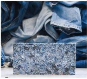
El textil reciclado se obtiene a partir de fibras textiles recuperadas de productos textiles que han llegado al final de su vida útil. Estas fibras textiles recicladas se procesan y transforman en un material adecuado para su uso como aislante térmico y acústico.
