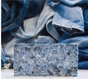
*Imagen 4. Textil reciclado como aislamiento térmico. FABRICK. (13)*
