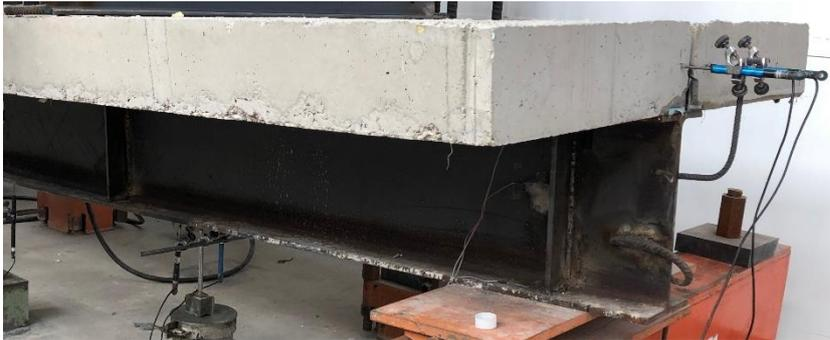
Figura 3.12: Rigidizadores y sección transversal de vigas ensayadas para el proyecto FIREDUCE
