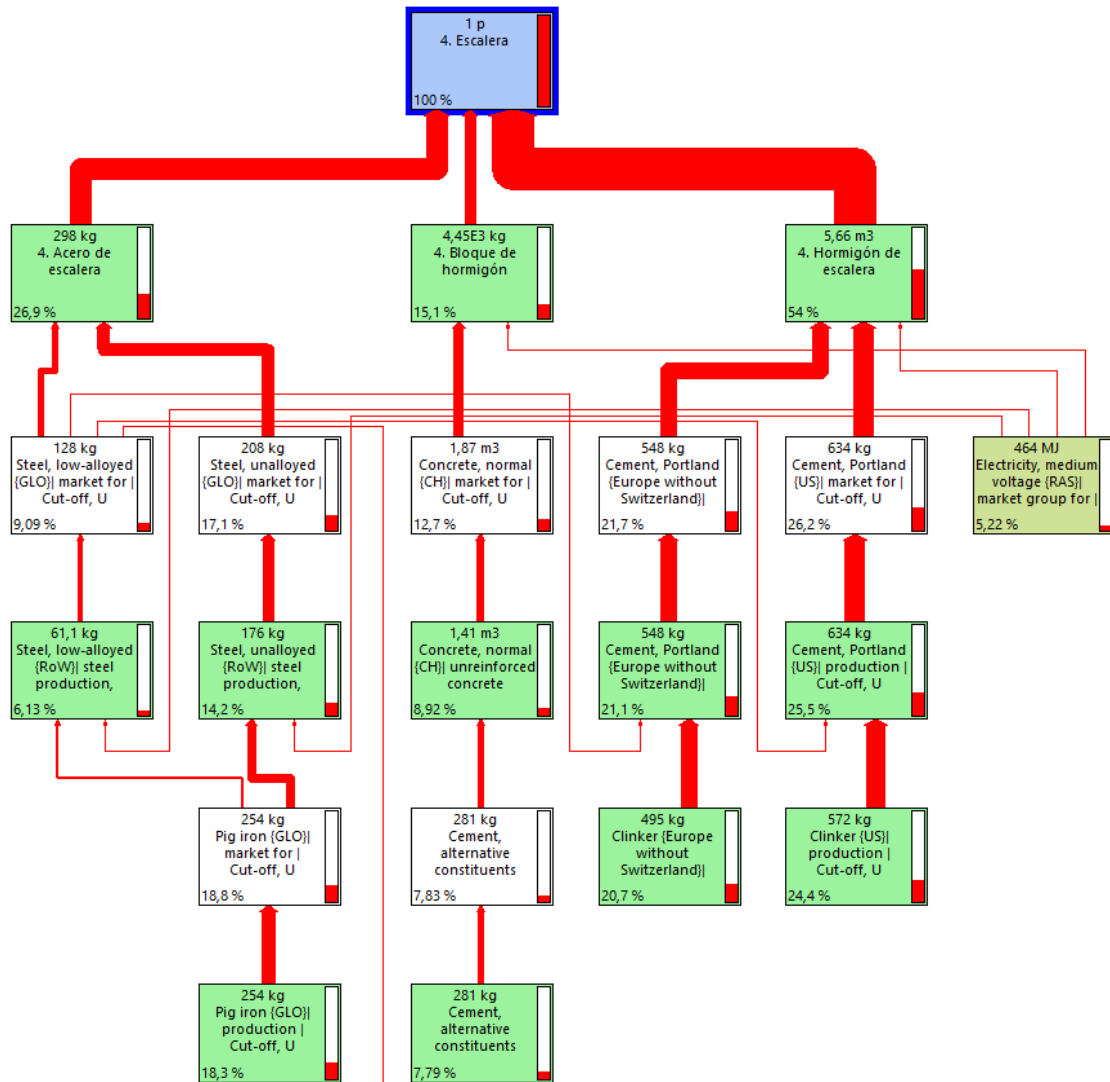
Figura 4.28. Diagrama de árbol para el daño de impacto al cambio climático de la etapa de la escalera in situ
