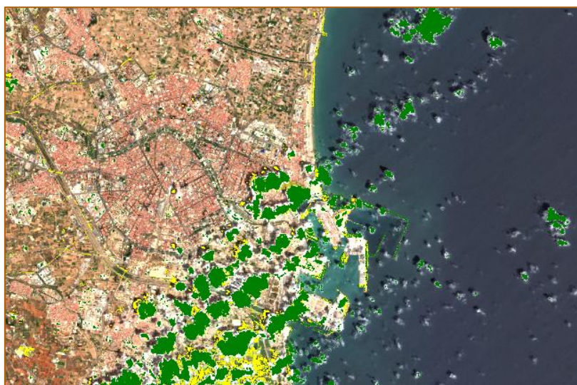
Ilustración 34. Representación de detección de nubes mediante el algoritmo CloudScore+. Fuente: Elaboración Propia.
