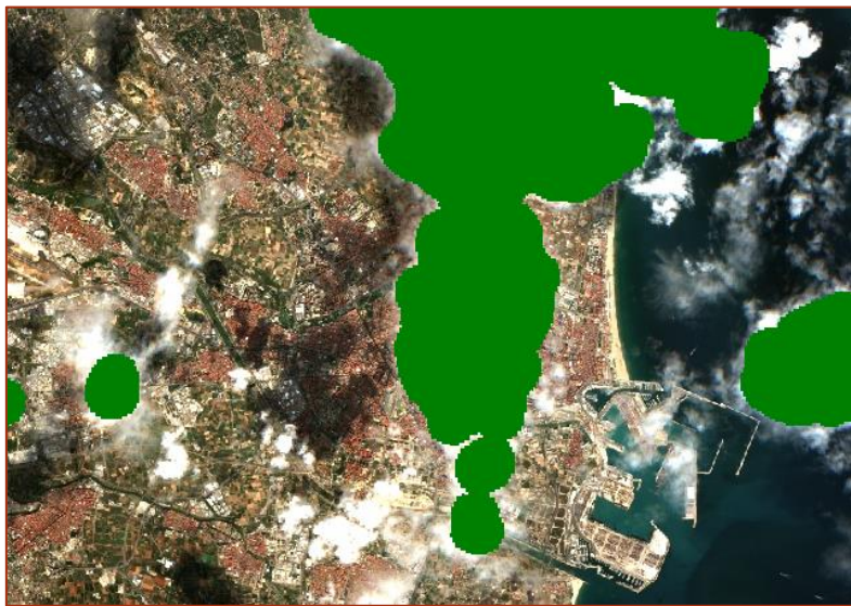
Ilustración 6. Visualización de la imagen con las nubes detectadas por el algoritmo de detección de nubes QA60. Fuente: Elaboración Propia.
