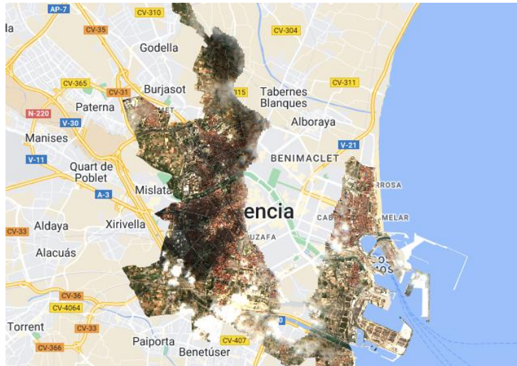
Ilustración 7. Visualización con la imagen enmascarada mediante el algoritmo QA60 sin nubes recortada para la ciudad de València. Fuente: Elaboración Propia.
