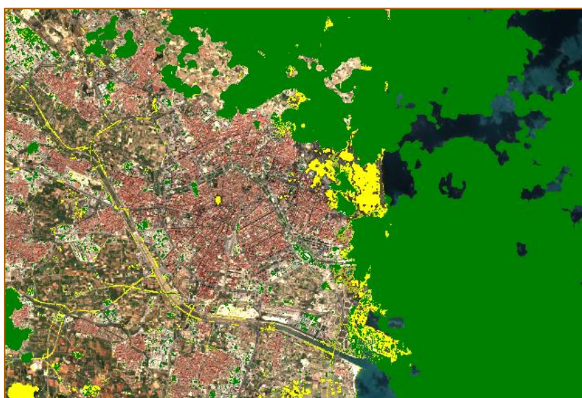
Ilustración 35. Representación de detección de nubes mediante el algoritmo CloudScore+. Fuente: Elaboración Propia.
