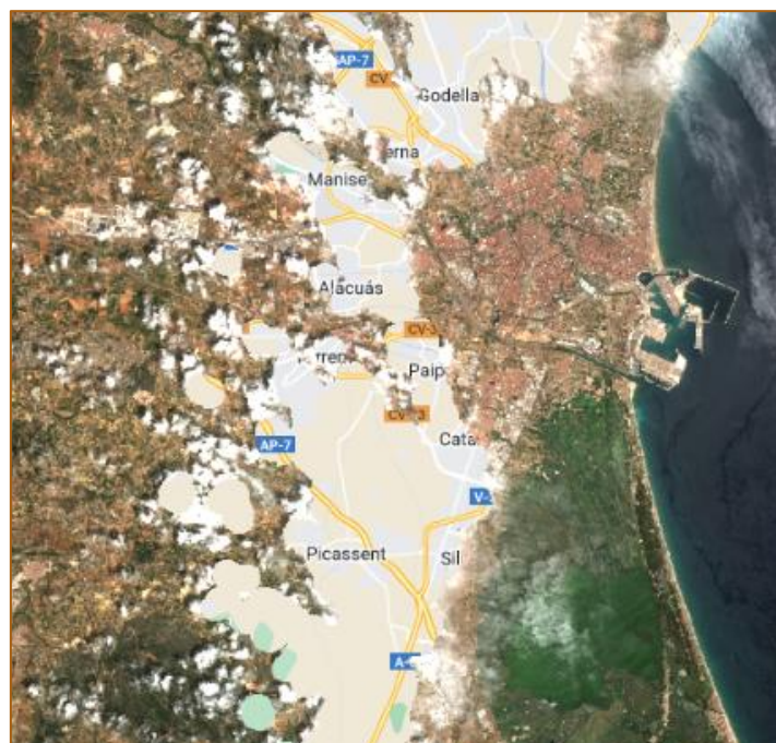
Ilustración 40. Representación de cómo funciona el algoritmo de enmascaramiento QA60. Fuente: Elaboración Propia.
