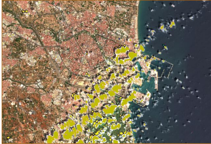
Ilustración 32. Representación de detección de nubes mediante el algoritmo S2CloudLess. Fuente: Elaboración Propia.
