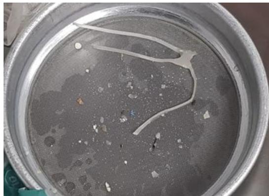
Figura 20. Residuos plásticos y no plásticos de una de las muestras de tomadas en la playa de Marenys de Rafalcaid en febrero del 2024, empleando el muestreo en línea de marea.
