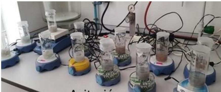
Figura 25. Agitación de las muestras durante el proceso de lixiviación
