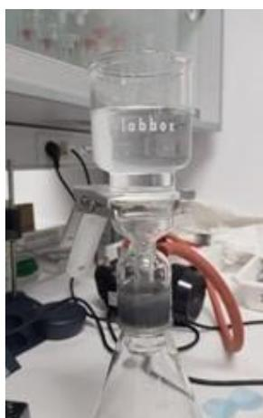
*Figura 24. Proceso filtración del agua de mar*
