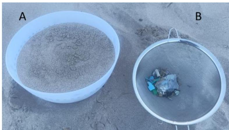
Figura 18. A. Recipiente con la arena tamizada en uno de los muestreos (la marca de puntos discontinuos indica que se han tamizado aproximadamente 5 Kg de arena). B. Colador con los residuos plásticos y otros residuos recogidos en uno de los puntos de m
