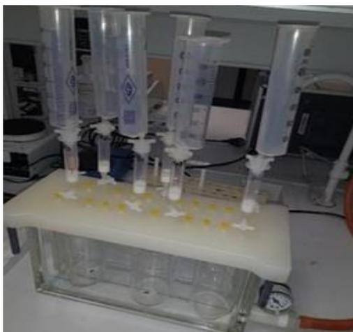
Figura 27. Sistema de vacío para extracción en fase sólida (SPE).
