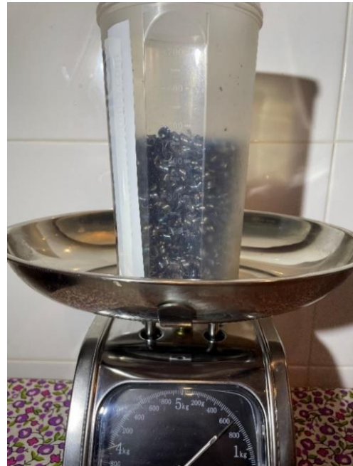
Figura 44.- Viruta semi circular en probeta de 500 ml
