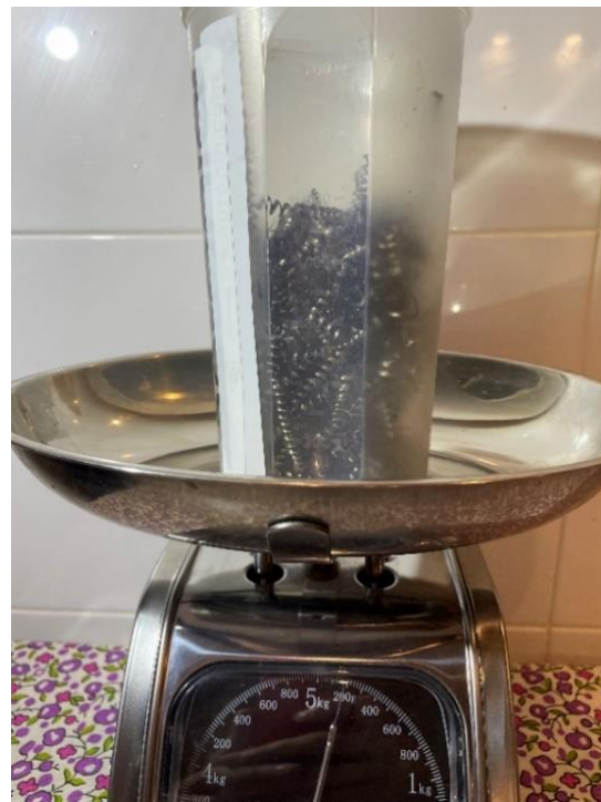
Figura 46.- Viruta espiral en probeta de 500 ml
