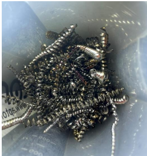
Figura 3.- Viruta Nº3 (Acero C45 con forma de espiral)
