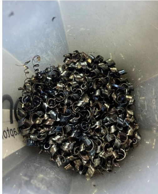
Figura 2.- Viruta Nº2 (Acero C45 con forma semi circular)
