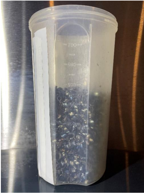
Figura 44.- Viruta semi circular en probeta de 500 ml
