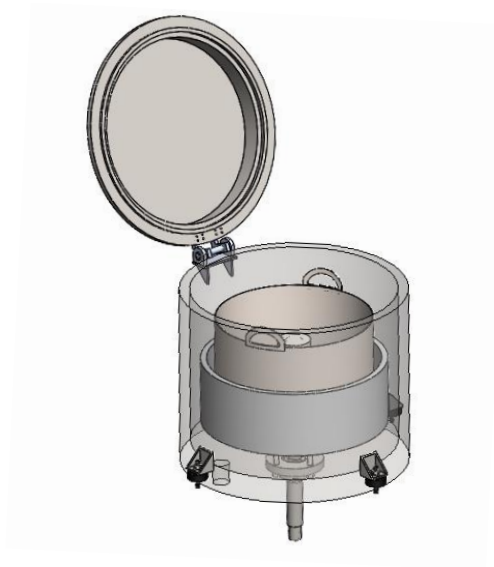
Figura 73.- Conjunto de piezas que soporta la estructura
