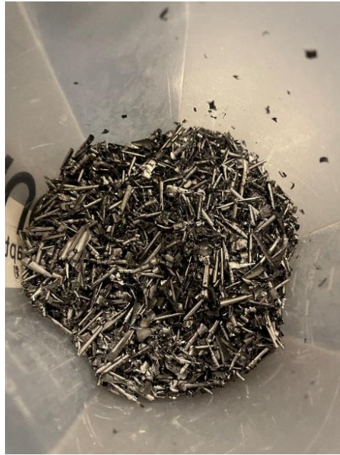
Figura 1.- Viruta Nº1 (Acero S355 J2 con forma plana)
