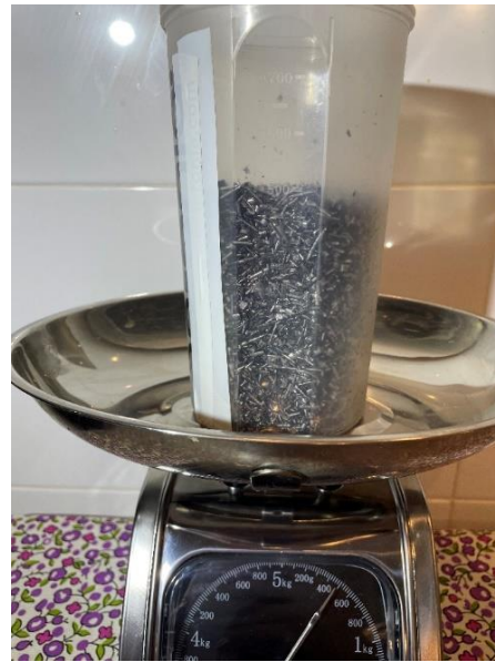
Figura 42.- Viruta plana en probeta de 500ml
