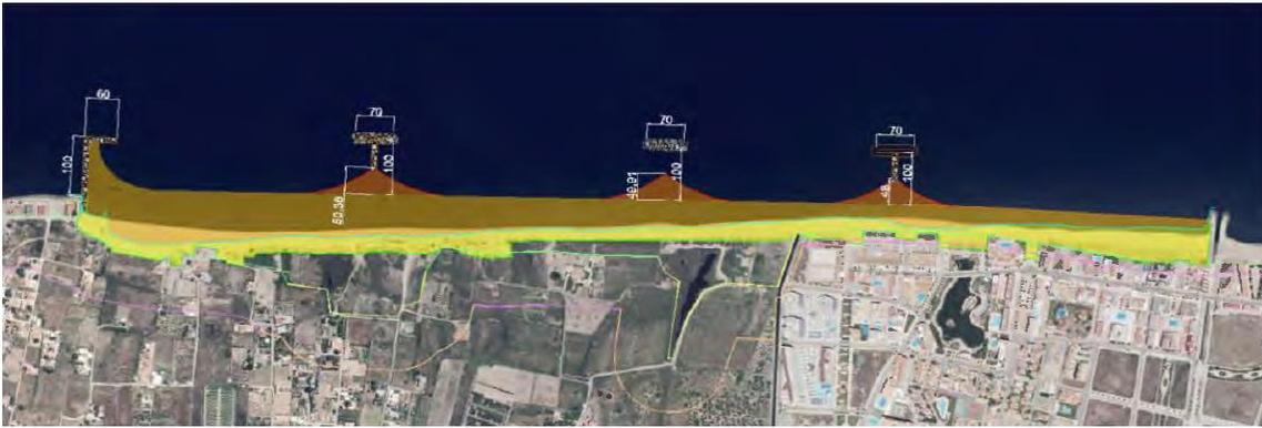
Figura 17. Forma de la playa con la línea de costa regenerada para la alternativa 3.
