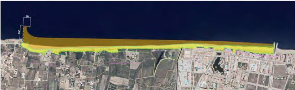
Figura 16. Forma de la playa con la línea de costa regenerada para la alternativa 2.
