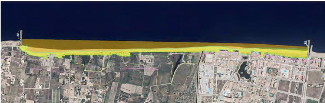
Figura 18. Forma de la playa con la línea de costa regenerada para la alternativa 4.
