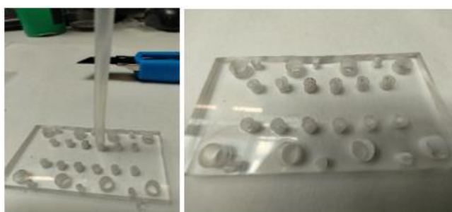
Figura 44. Solapamiento del exceso de los agujeros de canales con tubo de silicona.
