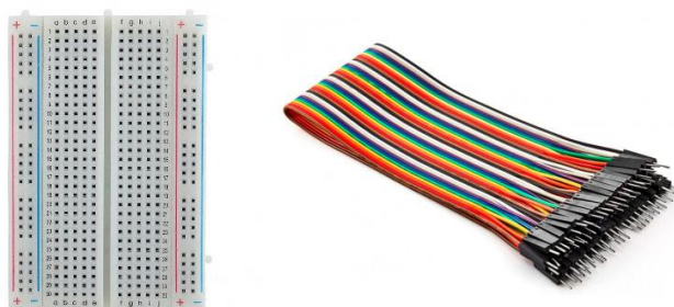
Figura 20. Placa Protoboard y conexiones macho-macho. (Cables tipo DuPont Macho - Macho (40 cm / 40 unidades) BricoGeek | BricoGeek.com, s. f.; Protoboard placa de 400 pines, s. f.)
