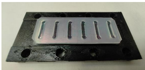
Figura 45. Posicionamiento de chips sobre la plataforma del cartucho con piezas de silicona para favorecer el solapamiento en las celdas.
