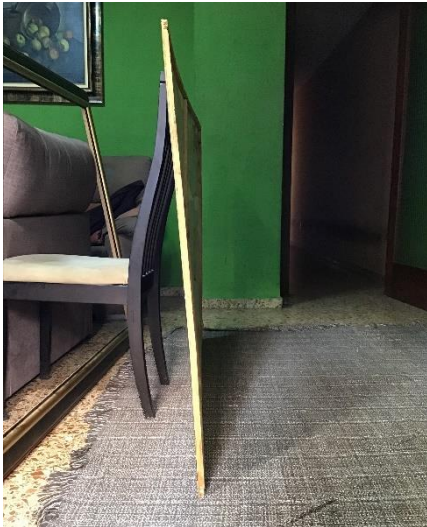
Figura 19. Foto general del perfil del a obra, donde se observa el grado de deformación que sufre. Uno de los daños principales de los tableros de contrachapado.
