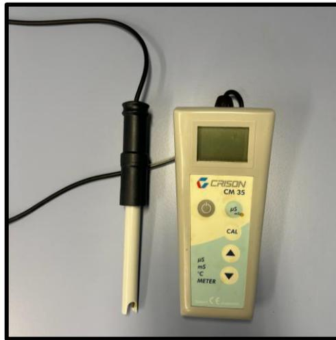
*Figura 28. Conductímetro*
