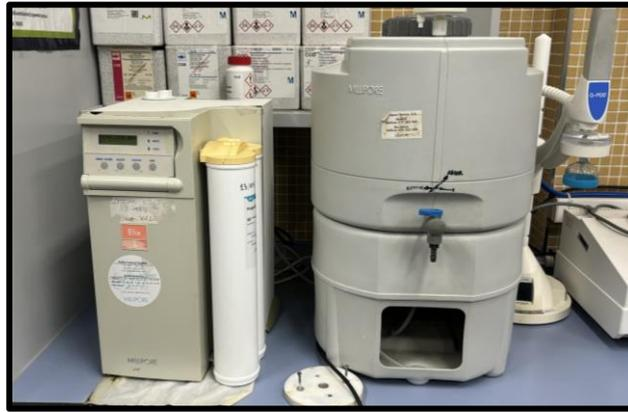
*Figura 22. Sistema de purificación de agua*
