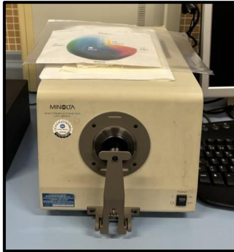
*Figura 34. Espectrofotómetro de reflexión*
