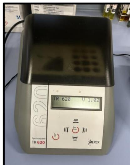
*Figura 23. Termorreactor*
