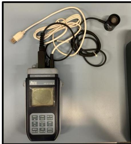
*Figura 36. Medidor de irradiación*
