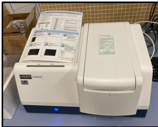
*Figura 27. Espectrofotómetro*
