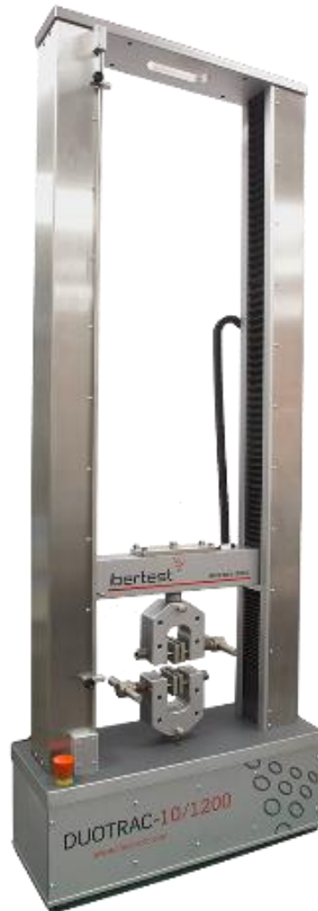
Figura 30. Equipo para ensayo de tracción.
