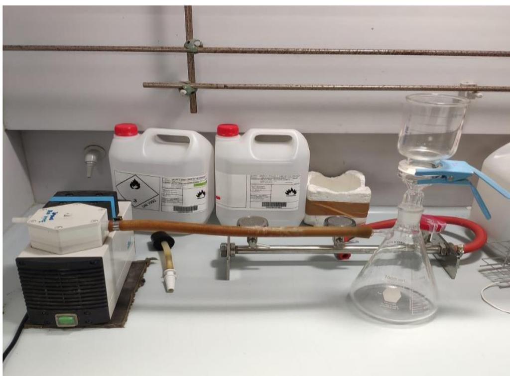
**Figura 6.** *Montaje empleado para la filtración de las muestras.*
