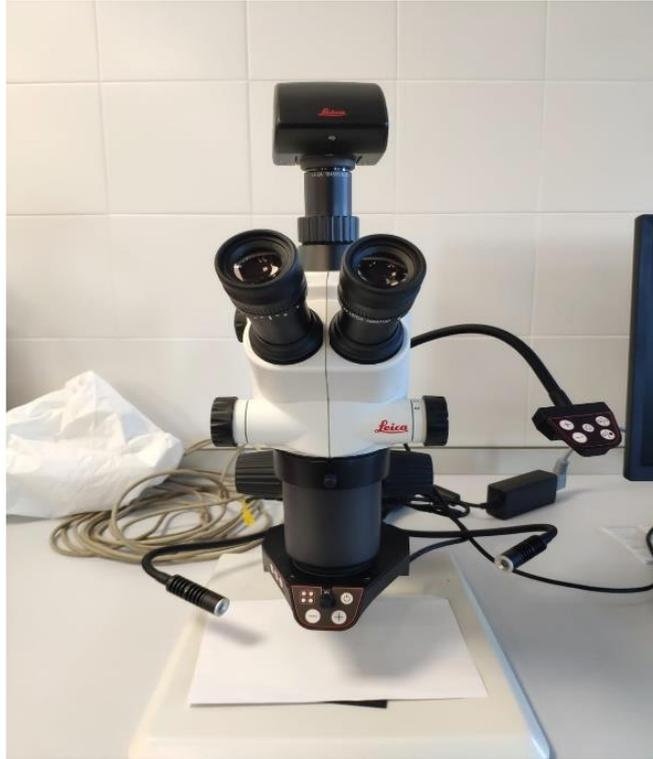
**Figura 10.** Estereomicroscopio Leica MZ APO utilizada para el conteo de microplásticos.
