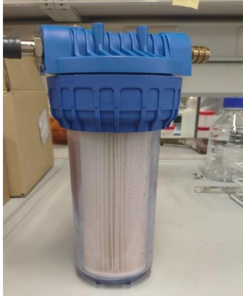
**Figura 14.** Montaje del filtro de cartucho empleado para el experimento de migración.
