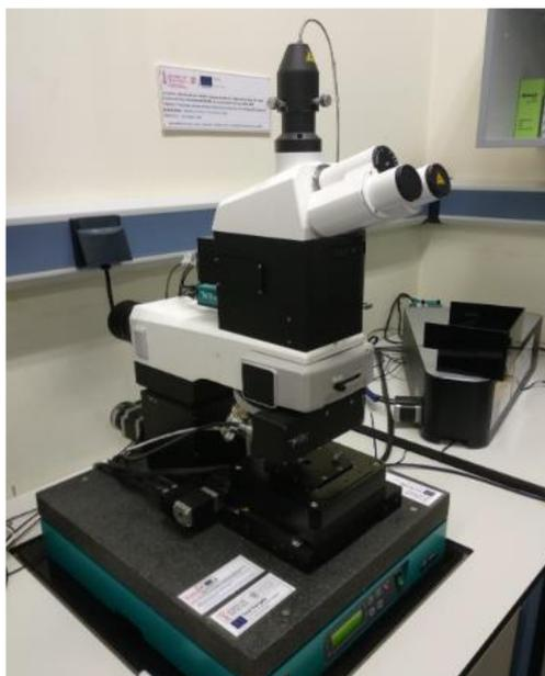
**Figura 16.** Equipo Raman WITec Alpha 300 utilizado en el análisis de las micropartículas.
