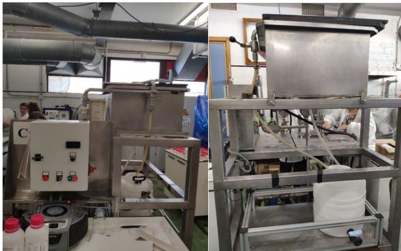
**Figura 15.** Planta piloto de Ósmosis inversa empleada para el experimento de migración.
