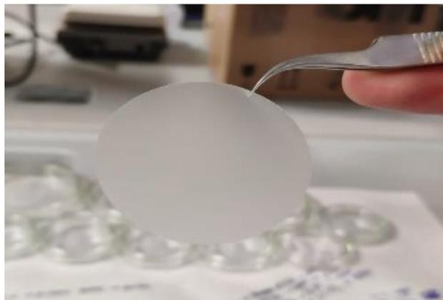
**Figura 5.** *Filtros Whatman nuclepore y pinzas de precisión utilizadas.*
