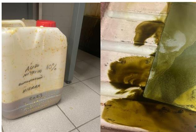
**Fig. 43.** Disolución de ácido nítrico y efectos sobre la plancha de hierro.
