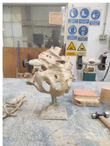
**Fig. 17.** Pieza en latón sin los bebederos innecesarios. Proceso de mecanización.
