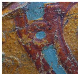
Fig.64.- Craquelado de la pintura con desprendimientos dejando a la vista la lámina metálica corlada
