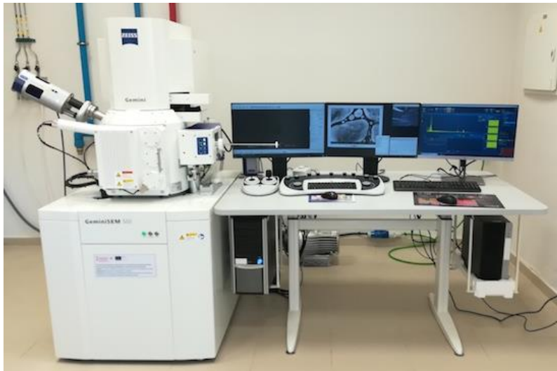
Figura 32. Equipo de FESEM, suministrado por Oxford Instruments.
