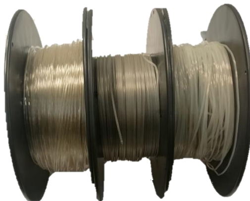
Figura 21. Filamentos obtenidos del procesado, empezando por la izquierda, PLA – PLA+10%TEC – PLA+20%TEC.
