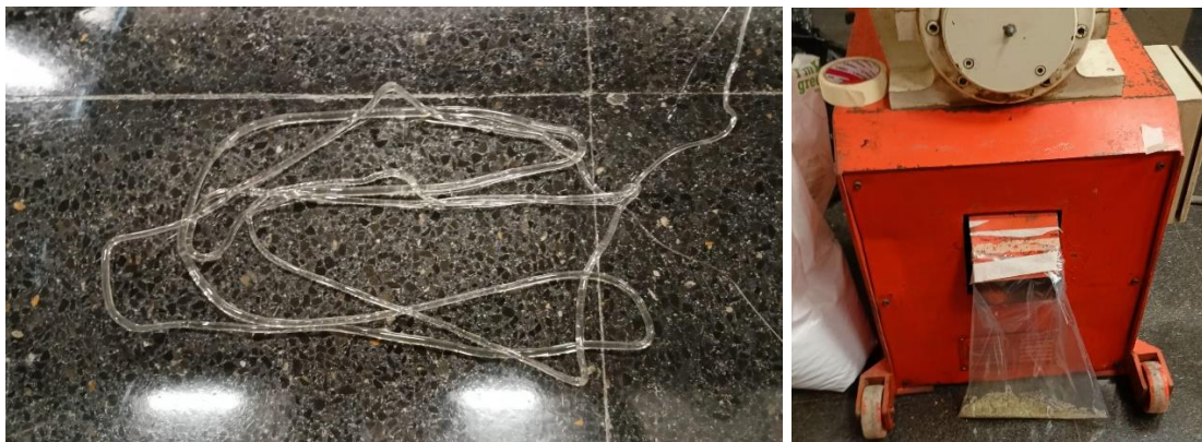
Figura 19. Material obtenido de la extrusora y granza obtenida de la molienda.
