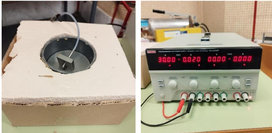
Figura 41. Fabricación casera para la determinación del coeficiente de conductividad térmica según la norma UNE-EN 12667-2001.
