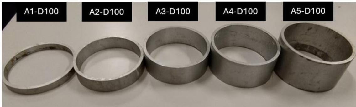
*Figura 24. Moldes de diferentes alturas para crear probetas cilíndricas de 100 mm de diámetro.*
