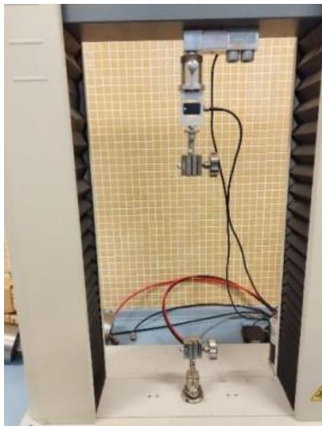
*Figura 37. Equipo de ensayo de tracción para hilos.*
