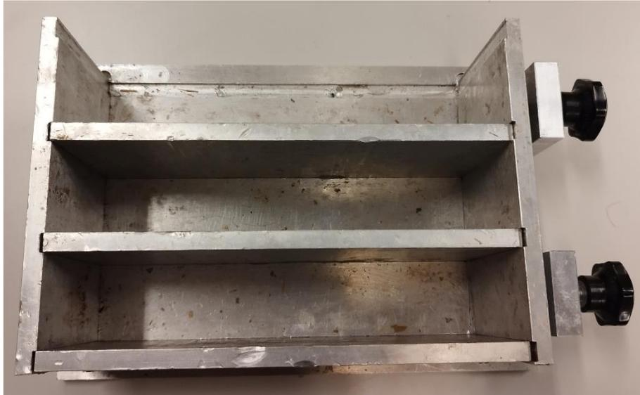
Figura 28. Molde en forma de ladrillo para probetas de ensayos mecánicos.
