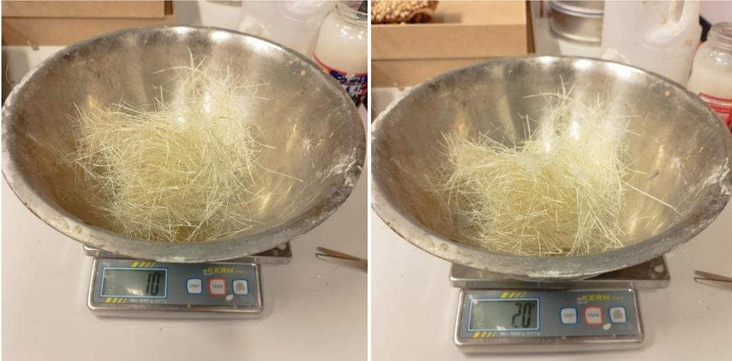
Figura 19. Peso de la primera muestra, 10 gramos de fibra y 10 gramos de adhesivo.
