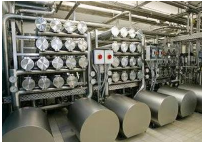
Figura 17 Filtración por membranas en industria láctea (Membranas y Sistemas de Filtración Para la Industria Láctea - Industria Alimentaria - s. f.)
