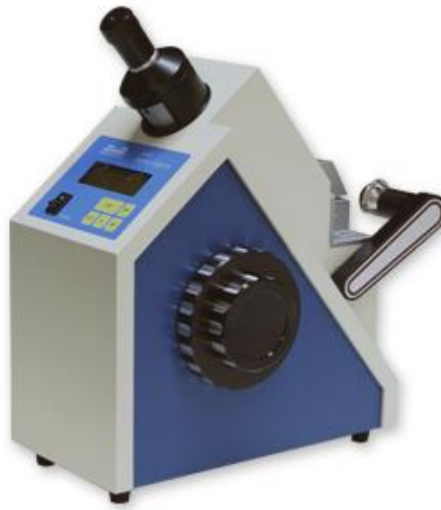
Figura 46 Refractómetro utilizado durante los ensayos de ultrafiltración
