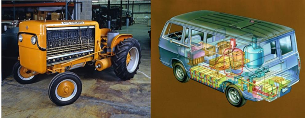
Figura 2.1: Tractor Allis-Chalmers propulsado mediante pila de combustible (izquierda) [4] y General Motors Electrovan (derecha) [5].
