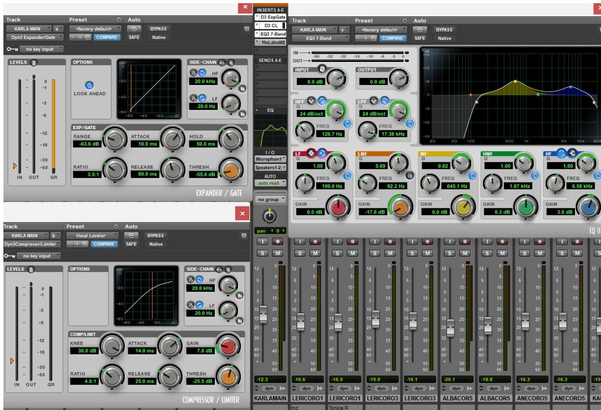
Figura 8. Procesadores insertados en la pista de VOZ.
