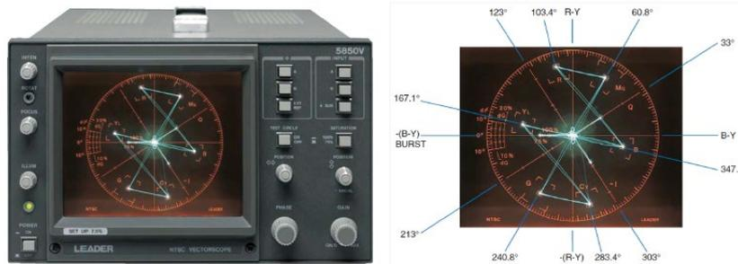
Figura 8. Vectorscopio e imagen ampliada
