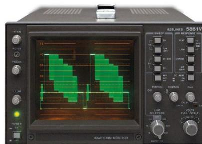
Figura 7. Monitor forma de onda
