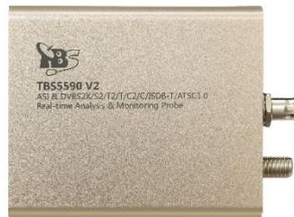
Figura 58. Tarjeta analizadora señal de TV
