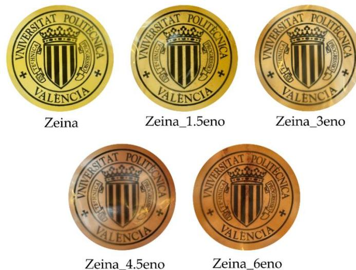
**Figura 33.** Imágenes de las películas de zeína con distintas composiciones de enocianinas, obtenidas mediante fotografía óptica.
