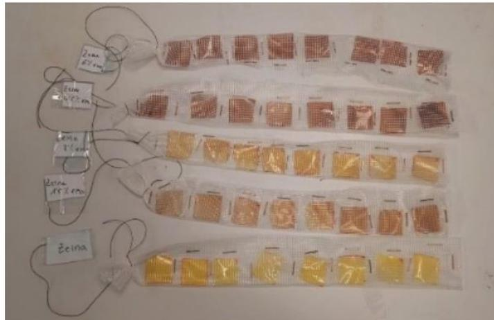
**Figura 25.** Preparación de las muestras para la realización de los ensayos de biodegradación.
