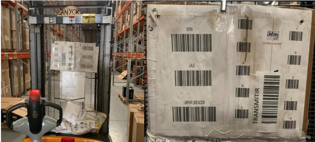
Ilustración 34: Códigos de barras para automatizar entradas y salidas de producto. Fuente: Elaboración propia.
