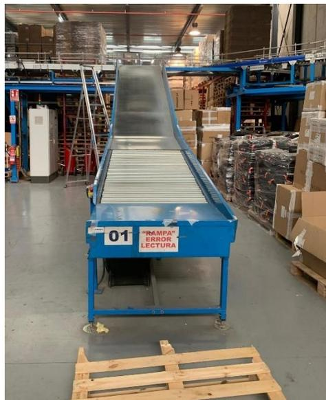
Ilustración 38: Rampa de error de lectura. Fuente: Elaboración propia.
