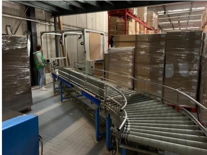
Ilustración 37: Rodillos de entrada a la cinta. Fuente: Elaboración propia.
