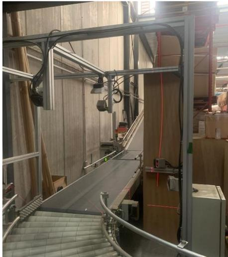
*Ilustración 20: Etiquetadora a continuación de la cinta telescópica. Fuente: Elaboración propia.*
