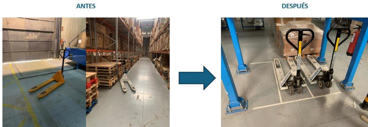
Ilustración 66: Delineado de ubicación para transpaletas manuales. Fuente: Elaboración propia.
