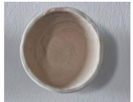
Fig. 67. Fórmula esmalte 2. Polvo de A. Cid. 2D2D. 15gr esmalte + 1gr polvo.
