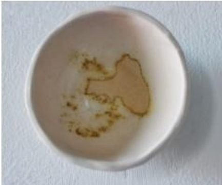
Fig. 50. Prueba 7. Polvo de las taquillas (BBAA). 7B. 15gr esmalte + 5gr polvo.
