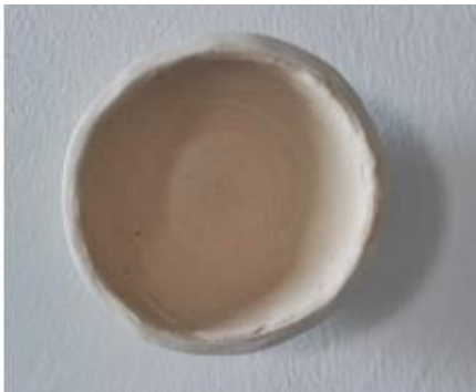
Fig. 62. Fórmula esmalte 2. Polvo de las taquillas (BBAA). 2D1B. 15gr esmalte + 5gr polvo.
