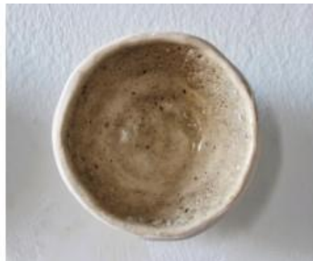
Fig. 45. Prueba 5. Polvo de G.V. Ramón y Cajal. 5C. 15gr esmalte + 3gr polvo.
