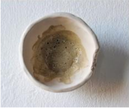
Fig. 33. Prueba 1. Polvo de A. Pérez Galdós. 1B. 15 gr esmalte + 5gr polvo.
