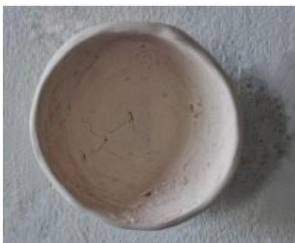
Fig. 56. Fórmula esmalte 1. Polvo de Historiador Diago. D1B. 15gr esmalte + 5gr polvo.
