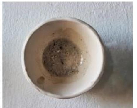
Fig. 38. Prueba 2. Polvo de A. Peris y Valero. 2D. 15gr esmalte + 1gr polvo.
