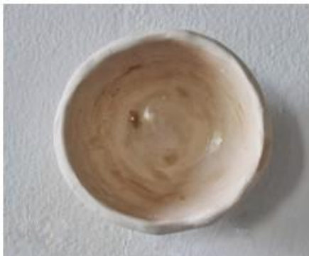
Fig. 53. Prueba 8. Polvo del filtro del aire (Punt d'Art). 8B. 15gr esmalte + 5gr polvo.
