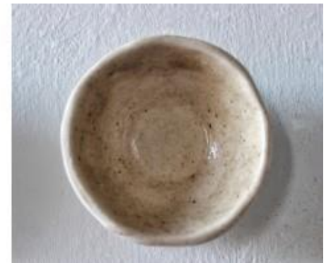
Fig. 46. Prueba 5. Polvo de G.V. Ramón y Cajal. 5D. 15gr esmalte + 1gr polvo.
