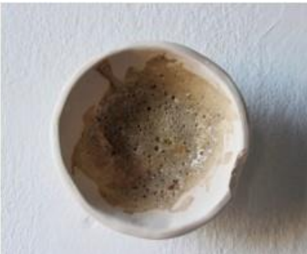
Fig. 36. Prueba 2. Polvo de A. Peris y Valero. 2B. 15gr esmalte + 5gr polvo.
