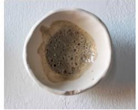
Fig. 35. Prueba 1. Polvo de A. Pérez Galdós. 1D. 15 gr esmalte + 1gr polvo.
