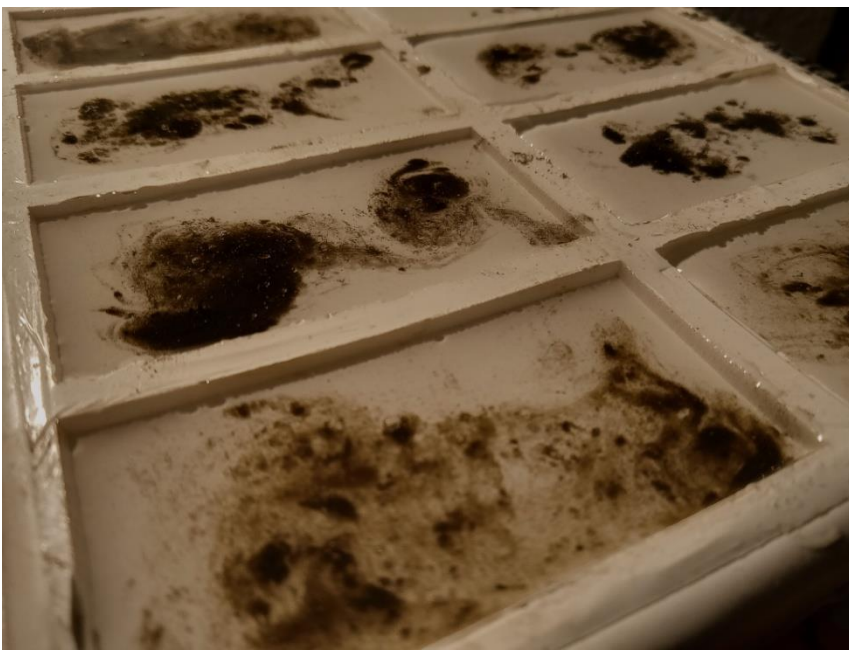
Fig. 78. Detalle de las encapsulaciones de polvo con resina epoxi.
