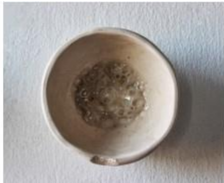
Fig. 37. Prueba 2. Polvo de A. Peris y Valero. 2C. 15gr esmalte + 3gr polvo.
