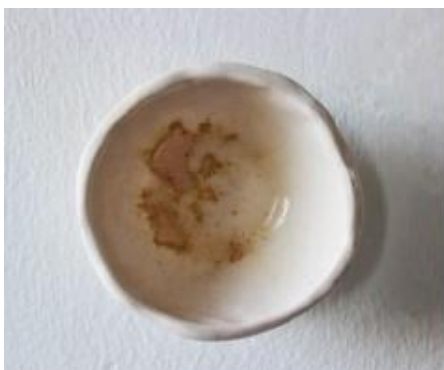
Fig. 47. Prueba 6. Polvo de Historiador Diago. 6B. 15gr esmalte + 5gr polvo.
