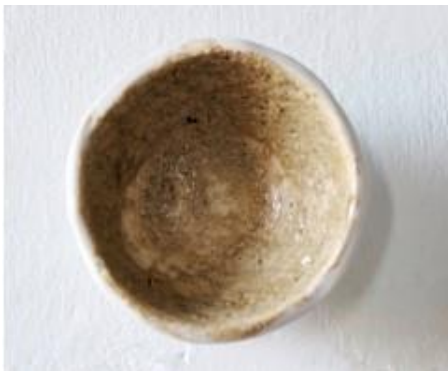
Fig. 44. Prueba 5. Polvo de G.V. Ramón y Cajal. 5B. 15gr esmalte + 5gr polvo.
