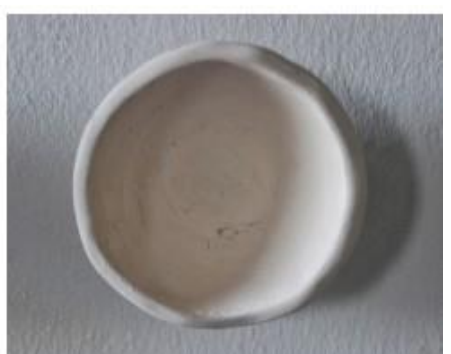
Fig. 58. Fórmula esmalte 1. Polvo de Historiador Diago. D1D. 15gr esmalte + 1gr polvo.
