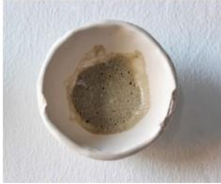
Fig. 34. Prueba 1. Polvo de A. Pérez Galdós. 1C. 15 gr esmalte + 3gr polvo.
