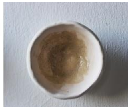
Fig. 40. Prueba 3. Polvo del Ágora, UPV. 3C. 15gr esmalte + 3gr polvo.
