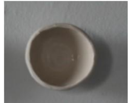
Fig. 55. Prueba 8. Polvo del filtro del aire (Punt d'Art). 8D. 15gr esmalte + 1gr polvo.
