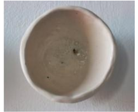
Fig. 43. Prueba 4. Polvo de la T4, UPV. 4D. 15gr esmalte + 1gr polvo.
