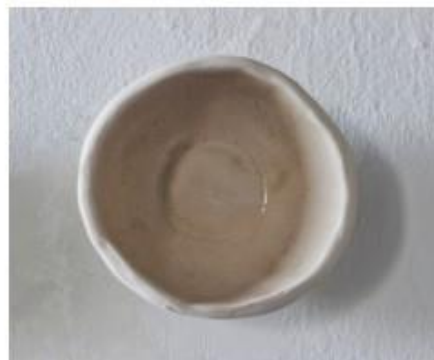
Fig. 54. Prueba 8. Polvo del filtro del aire (Punt d'Art). 8C. 15gr esmalte + 3gr polvo.
