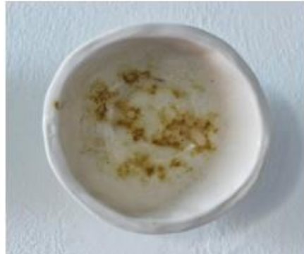
Fig. 51. Prueba 7. Polvo de las taquillas (BBAA). 7C. 15gr esmalte + 3gr polvo.
