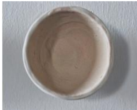
Fig. 63. Fórmula esmalte 2. Polvo de las taquillas (BBAA). 2D1C. 15gr esmalte + 3gr polvo.
