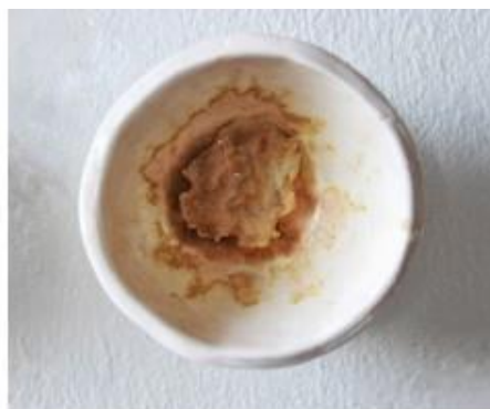
Fig. 48. Prueba 6. Polvo de Historiador Diago. 6C. 15gr esmalte + 3gr polvo.
