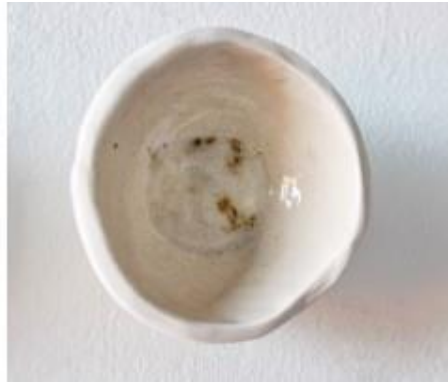
Fig. 42. Prueba 4. Polvo de la T4, UPV. 4C. 15gr esmalte + 3gr polvo.
