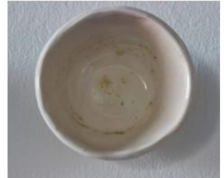
Fig. 52. Prueba 7. Polvo de las taquillas (BBAA). 7D. 15gr esmalte + 1gr polvo.
