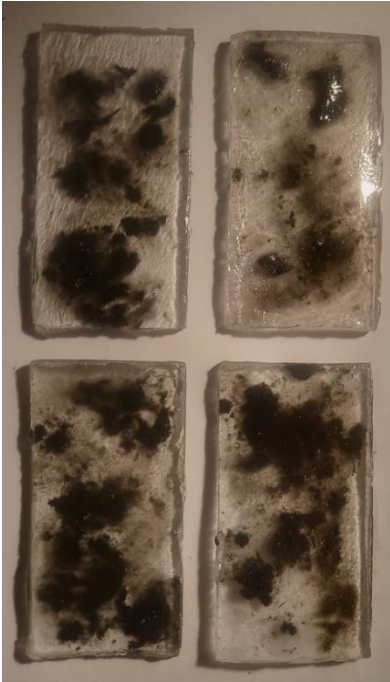
Fig. 76. Pruebas de encapsulaciones con bioplástico rígido de gelatina.
