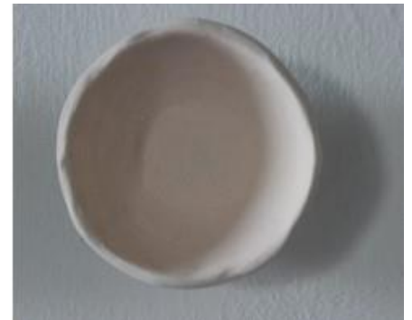
Fig. 64. Fórmula esmalte 2. Polvo de las taquillas (BBAA). 2D1D. 15gr esmalte + 1gr polvo.
