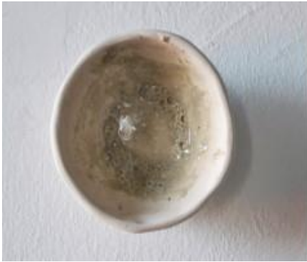
Fig. 41. Prueba 4. Polvo de la T4, UPV. 4B. 15gr esmalte + 5gr polvo.
