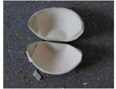
Fig. 61. Fórmula esmalte 1. Polvo de las taquillas (BBAA). D2D. 15gr esmalte + 1gr polvo.
