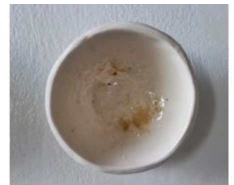
Fig. 49. Prueba 6. Polvo de Historiador Diago. 6D. 15gr esmalte + 1gr polvo.
