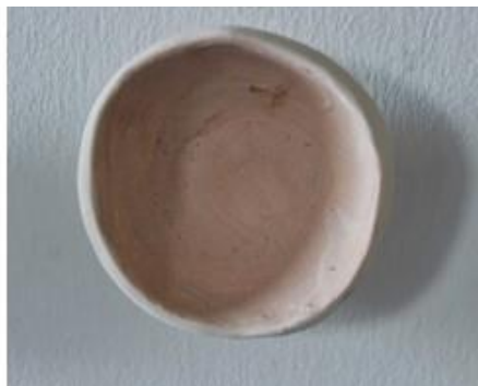
Fig. 66. Fórmula esmalte 2. Polvo de A. Cid. 2D2C. 15gr esmalte + 3gr polvo.
