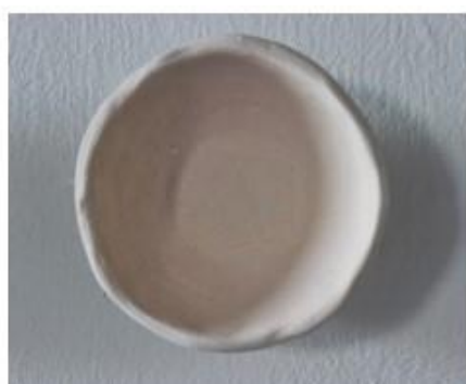
Fig. 57. Fórmula esmalte 1. Polvo de Historiador Diago. D1C. 15gr esmalte + 3gr polvo.
