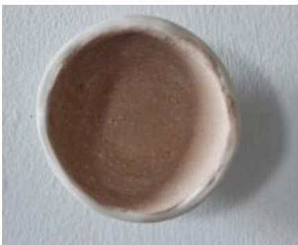
Fig. 65. Fórmula esmalte 2. Polvo de A. Cid. 2D2B. 15gr esmalte + 5gr polvo.
