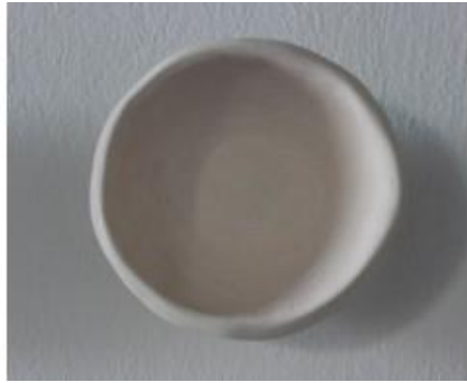
Fig. 60. Fórmula esmalte 1. Polvo de las taquillas (BBAA). D2C. 15gr esmalte + 3gr polvo.
