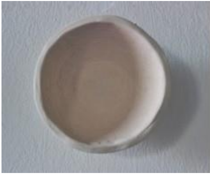
Fig. 59. Fórmula esmalte 1. Polvo de las taquillas (BBAA). D2B. 15gr esmalte + 5gr polvo.
