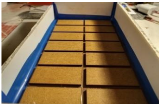
Fig. 42. Construcción de los tabiques con cartón pluma y cinta aislante.
