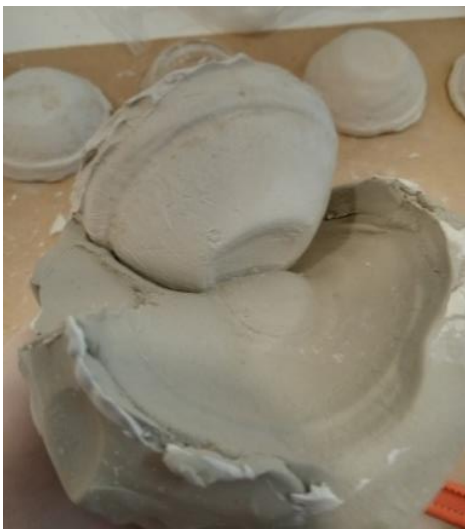
Fig. 26. Desmoldeo del positivo.
