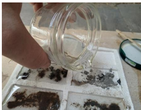
Fig. 44. Vertido de resina epoxi sobre el polvo recolectado.
