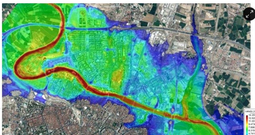
Figura 25 Zona Inundable en Caso de Rotura
