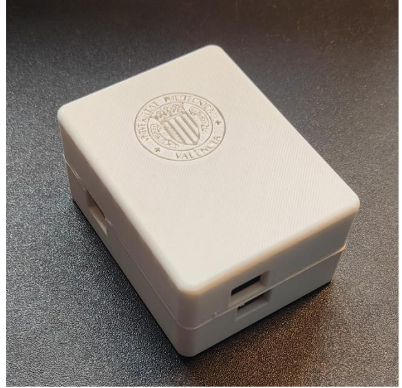
Figura 45. Resultado de la impresión 3D de la caja a partir del modelo diseñado en Fusion 360.
