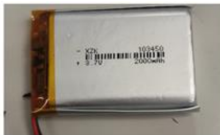
Figura 22. Batería recargable de 3.7 V (2000mAh)
