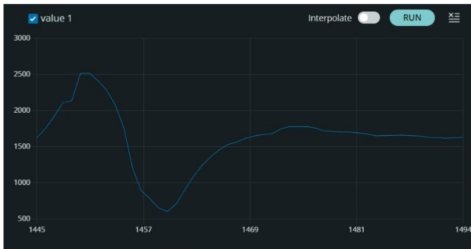
Figura 52. Gráfica que muestra los valores de voltaje obtenidos en el sensor al contraer el músculo estudiado. Eje X: muestras; Eje Y: mV. Frecuencia de muestreo: 10 Hz.
