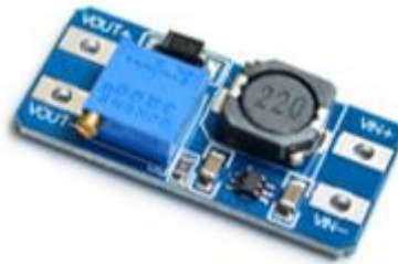
Figura 25. Convertidor DC/DC con potenciómetro. 14
