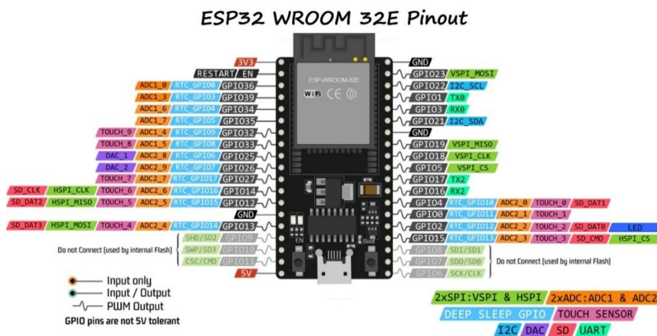
Figura 49. Distribución de pines del ESP32 WROOM 32E. 22
