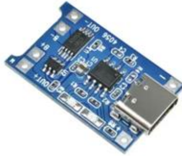
Figura 23. Módulo de carga TP4056 con puerto USB-C. 12
