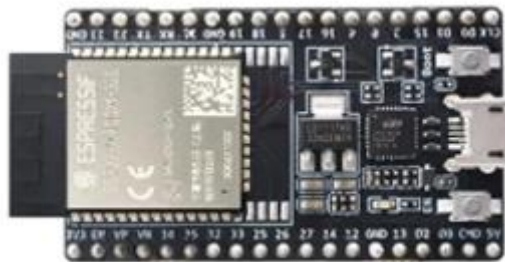
Figura 26. Microcontrolador ESP32 WROOM 32-E, con capacidad de conexión Bluetooth. 15
