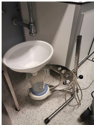
Figura 12. Flujómetro utilizado para medir el flujo expulsado por el paciente durante la sesión (ml/s).
