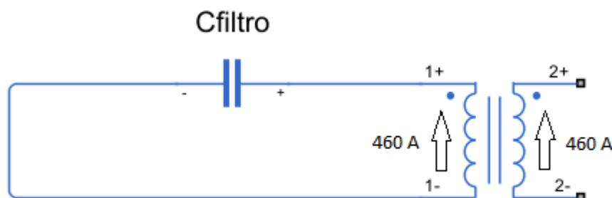
Figura 37. Circuito equivalente sin la influencia del inversor
