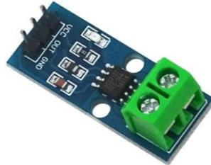
*Ilustración 8: Apariencia de los sensores de medición de corriente de la serie ACS712.*
