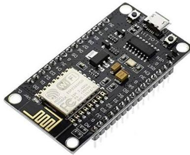
*Ilustración 5: Apariencia de una tarjeta NodeMCU que emplea ESP8266 como base.*
