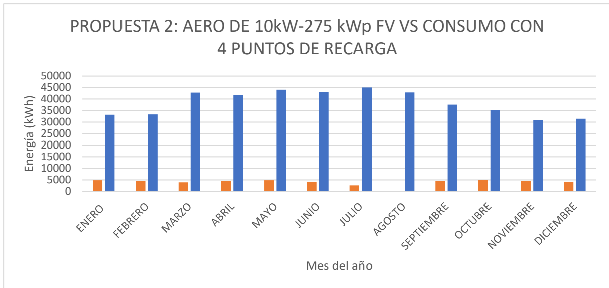
Ilustración 30: consumo vs producción híbrida para 4 puntos de recarga según la propuesta 2
