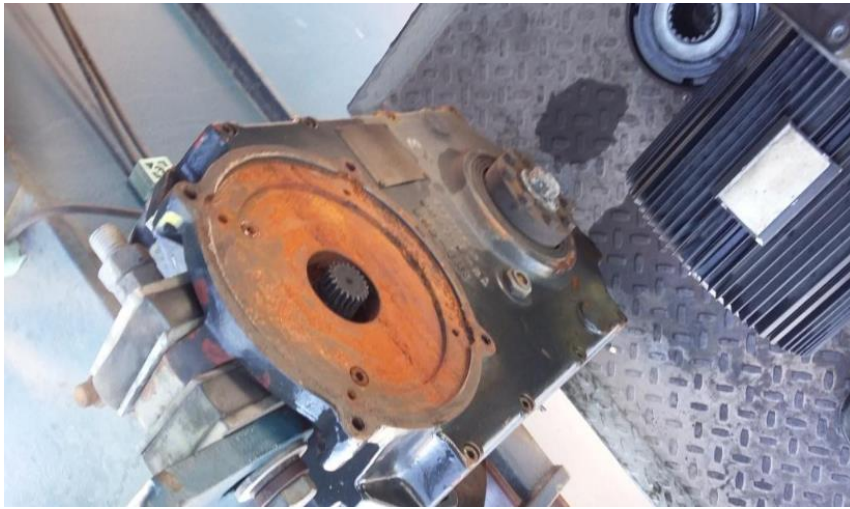
Figura 11 Motor del carro (derecha) desacoplado del eje reductor (izquierda) (Villodres Martín, 2017)
