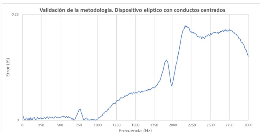
Gráfica 31. % Error en el cálculo de la  $TL$  en ANSYS APDL frente ANSYS Workbench. Dispositivo elíptico con conductos centrados
