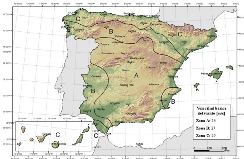
Figura 43. Valor básico de la velocidad del viento (Fuente: CTE DB SE-AE [69])
