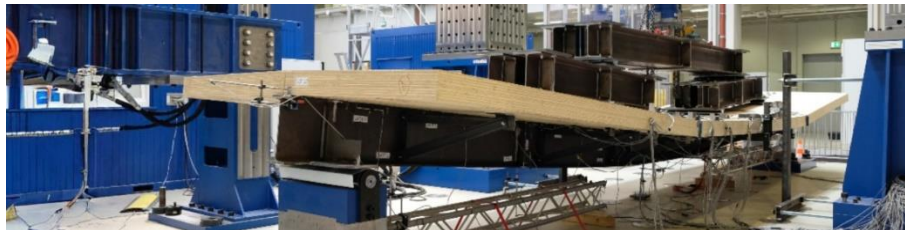
Figura 42. Configuración del ensayo a flexión de PreFa-SeTi [66]
