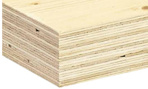
Figura 38. Sección de un tablero de madera LVL [64]
