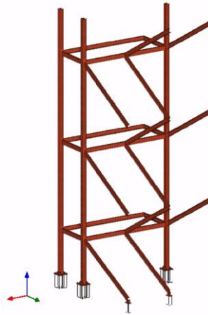
Figura 33. Subestructura del núcleo de escaleras
