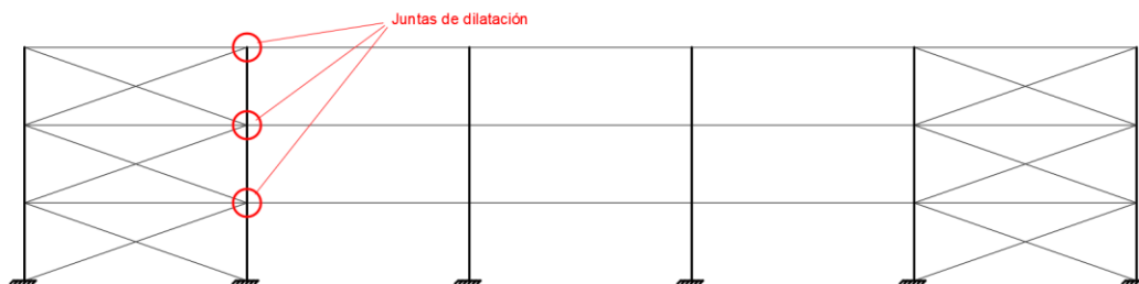
Figura 37. Posición de las juntas de dilatación
