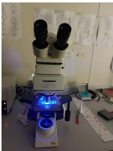
Figura 8. Microscopio epifluorescente Leica DM 2500 y vista de un campo con las células.
