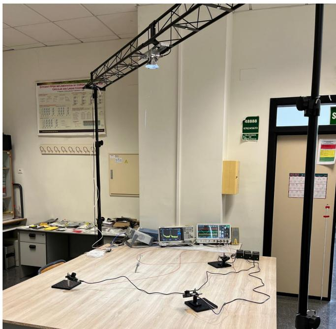
**Figura 1.1: Banco de pruebas del enlace de comunicaciones con VLC**
