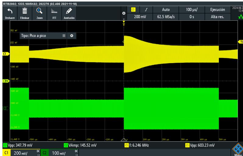
Figura 6.4: Entrada (verde) y salida (amarilla) con el AGC funcionando y  $kp = 2^{-13}$
