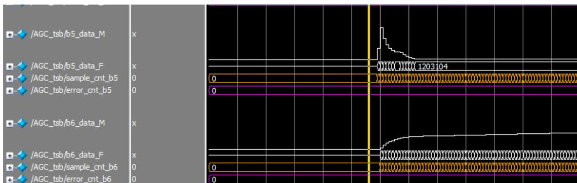
**Figura 5.15: Validación del módulo del multiplicador y acumulador del AGC siendo  $kp=0,005$**
