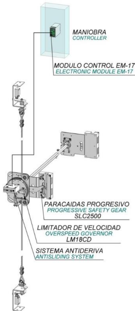
Figura 12. Sistema de montaje del paracaídas
