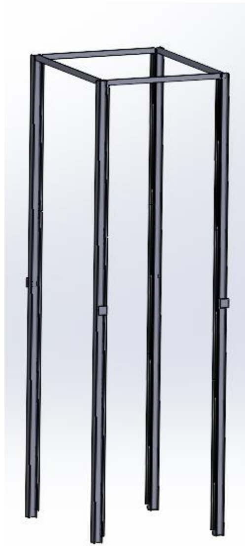
Figura 9. Conjunto estructura portante y guías.
