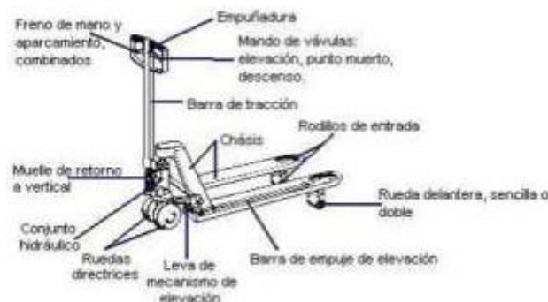
Figura 7. Partes de una carretilla
