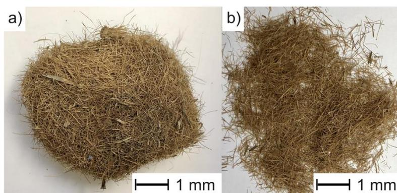
**Figura III.3.1.** Imágenes de a) bola fibrosa de *Posidonia oceanica* tal como se recibe y b) fibras de *Posidonia oceanica* (PO) después del proceso de limpieza. Imágenes con una escala de marcador de 1 mm.
