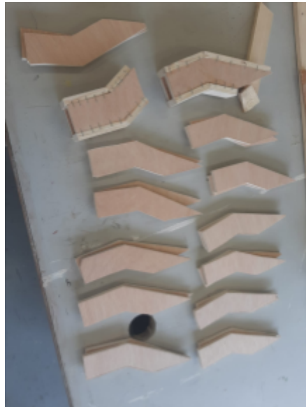
Imagen 51: pieza de conexión entre las columnas verticales y el techo
