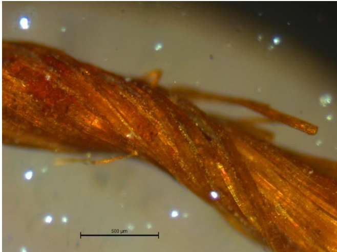
Figura 33: hilo de lino observado al microscopio óptico con luz transmitida a 4x.
