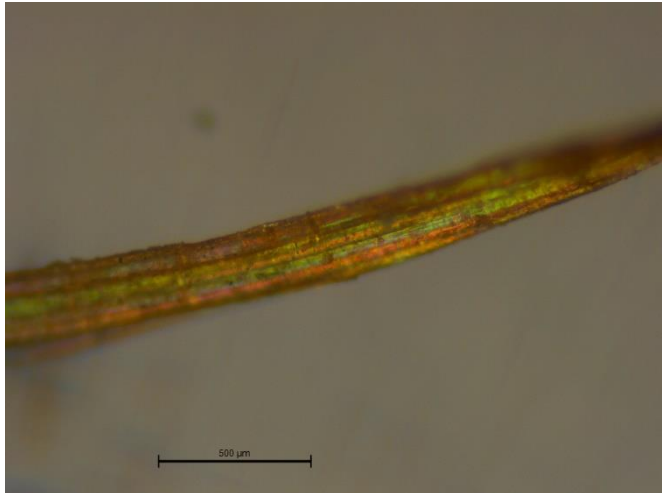
Figura 34: Fibra de lino observada al microscopio óptico con luz transmitida a 10x.
