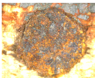
Figura 24 ; Clavos de tensado Figura 25: Cabeza clavo oxidado
