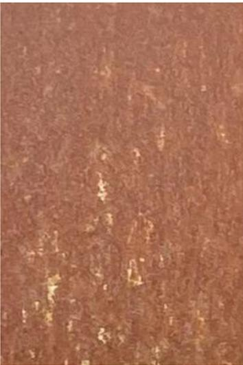
Figura (15): Fotografía de detalle de la corrosión superficial del acero de la espiral de la obra de Kike Gordillo.
