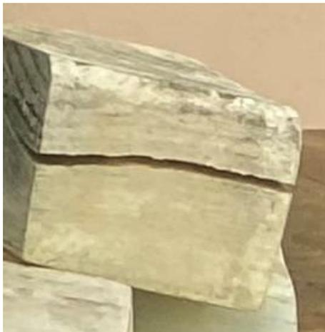
Figura (17): Fotografía de detalle de las grietas que tiene la madera de pino de la base de la obra “Espiral”.
