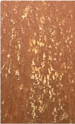
Figura (16): Fotografía de detalle de las escamas del óxido formados en la superficie de la espiral de acero de la obra de Kike Gordillo.
