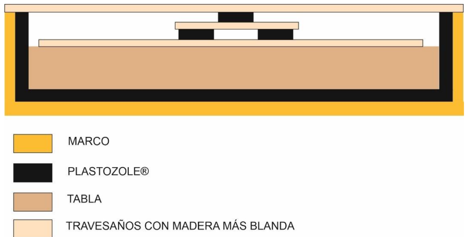
Figura 46- Croquis sistema de refuerzo.
