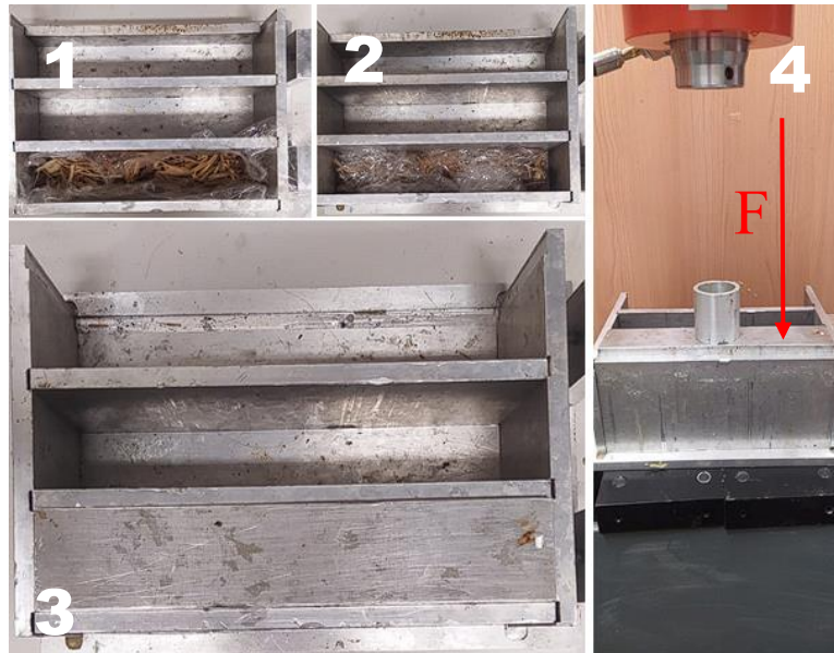
Figura 50. Molde en forma de ladrillo para probetas.
