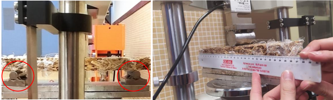
Figura 61. Montaje y centrado de las probetas en máquina de ensayos.
