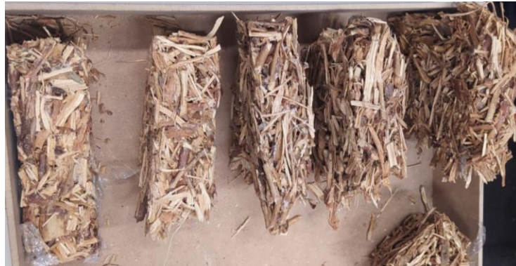
Figura 63. Preparación de probetas para ensayo compresión.
