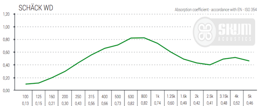
Figura 74. Panel acústico SCHÄCK WD con núcleo de espuma acústica ZHFR28 y acabado en madera [67].
