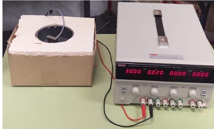
Figura 66. Determinación de coeficiente de conductividad térmica por placa caliente de fabricación casera según norma UNE-EN 12667-2001.
