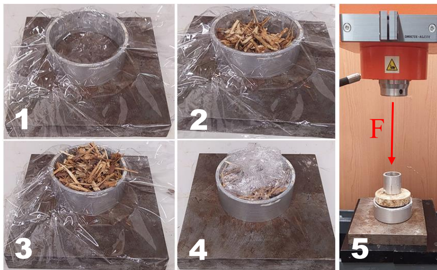
Figura 48. Proceso de creación de las probetas en moldes circulares (1,2, 3, 4) y su prensado (5).
