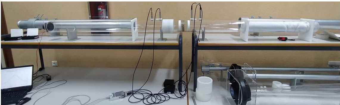
Figura 56. Ensayo de pérdida de transmisión de sonido (STL).
