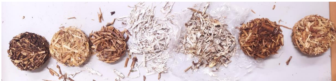
Figura 34. Distintos tipos de adhesivos y aglutinantes mezclados con restos de poda de almendro.
