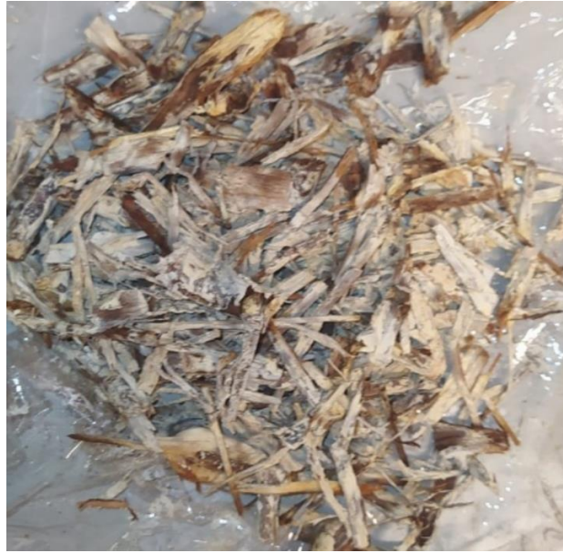
Figura 37. Restos de poda de almendro con mortero de cal.
