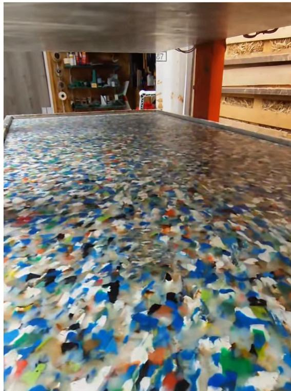
Ilustración 66. Plancha comprimida
