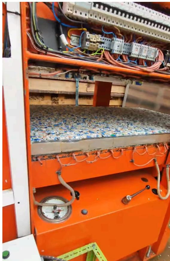
Ilustración 65. Compresión del molde
