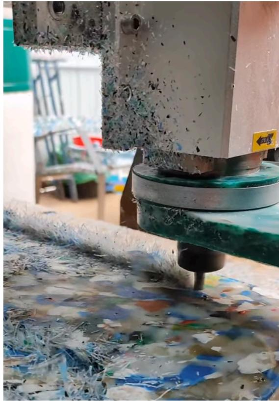
Ilustración 69. Proceso de corte
