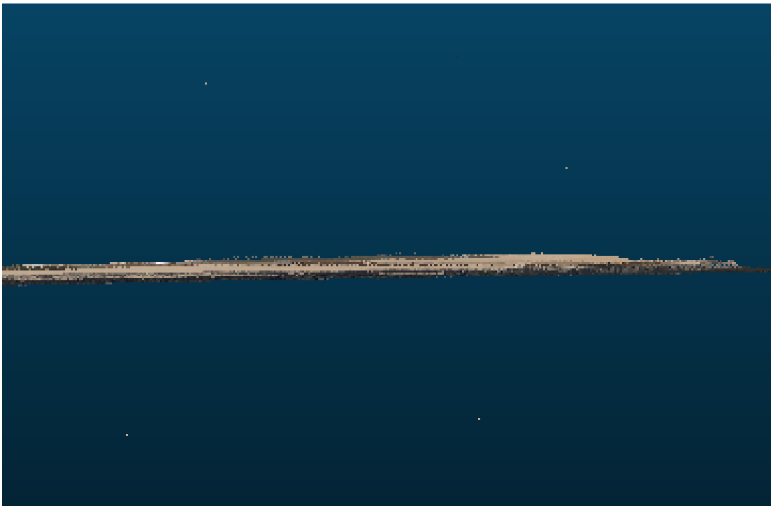
Figura 7. Ejemplo de outliers en datos LiDAR. La imagen corresponde a una visión de perfil de los datos LiDAR del año 2015 en el tramo norte del área de estudio. La visualización de los datos se realizó a través del programa Cloud Compare ( https://www.cloudcompare.org/ ). Fuente: Elaboración propia.
