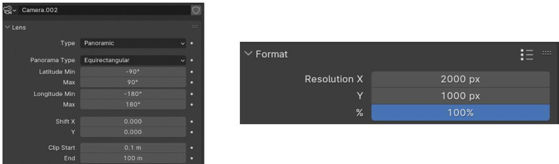
Figura 32: Izquierda: Configuración de la cámara Panoramic. Derecha: Configuración de la resolución de los píxeles para la imagen 360.
